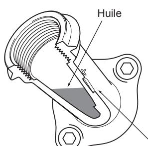
L'on voit ici le niveau d'huile; les marques MAX et MIN permettent d'en vérifier la quantité.
