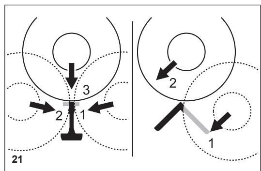
En el corte con agua, el disco se moja por ambos lados a una tasa constante mediante un chorro de agua. MAKITA ofrece los accesorios adecuados para las aplicaciones de corte con agua (vea también "ACCESORIOS ESPECIALES").
